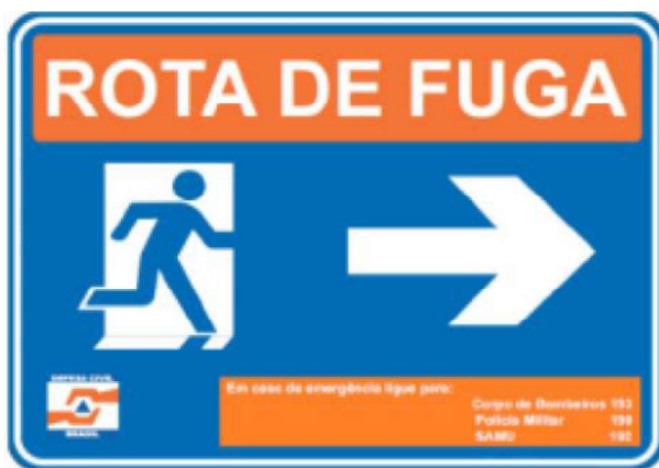
Figura 5 – Placa para rota de fuga
