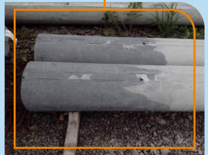
Base de concreto condutivo
