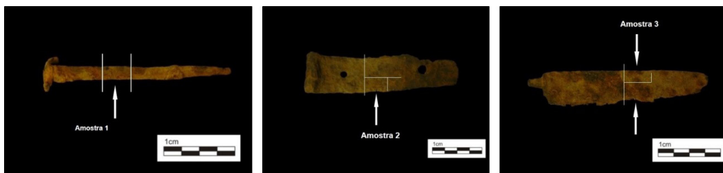
Figura 5. Indicação dos cortes longitudinais realizados para o embutimento das três amostras analisadas Fonte: Troncoso (2013).
