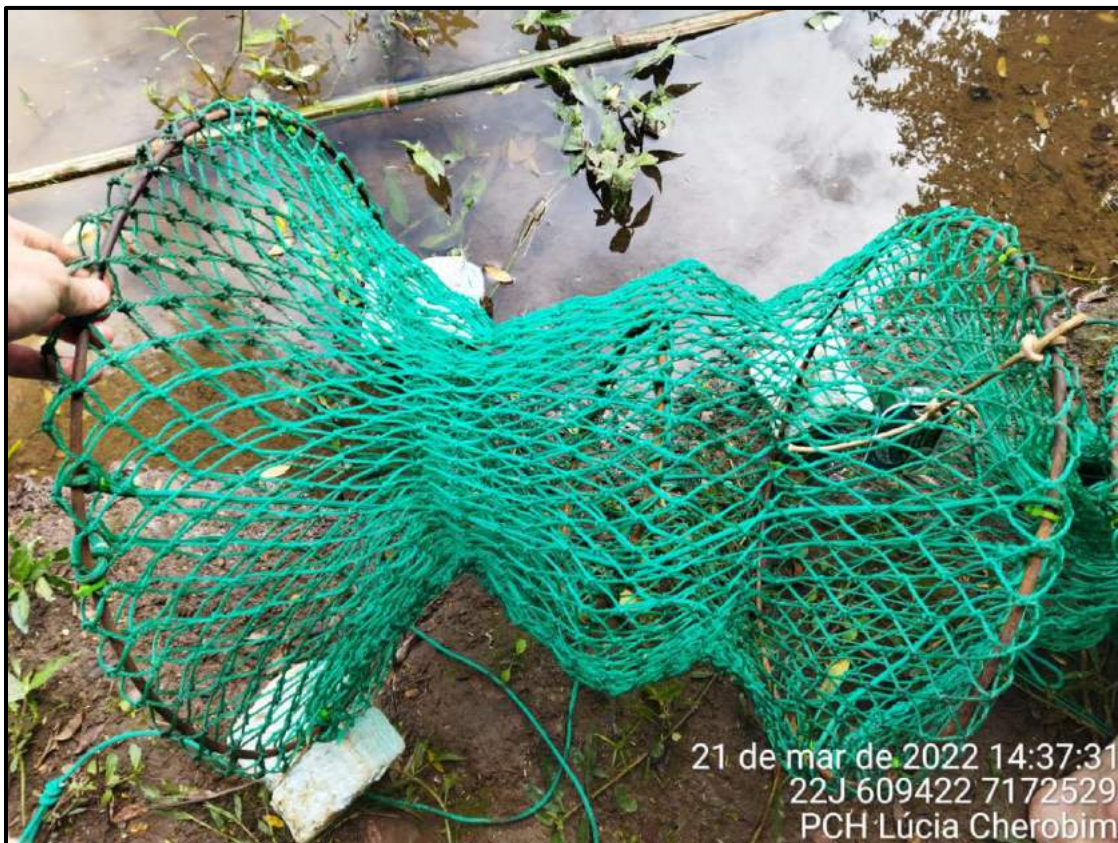
Figura 15 – Estrutura de covo circular utilizado para monitoramento de quelônios dulcícolas nas áreas de soltura.
