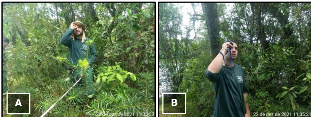
Figura 3 – Medição de altura das araucárias com clinômetro digital.
