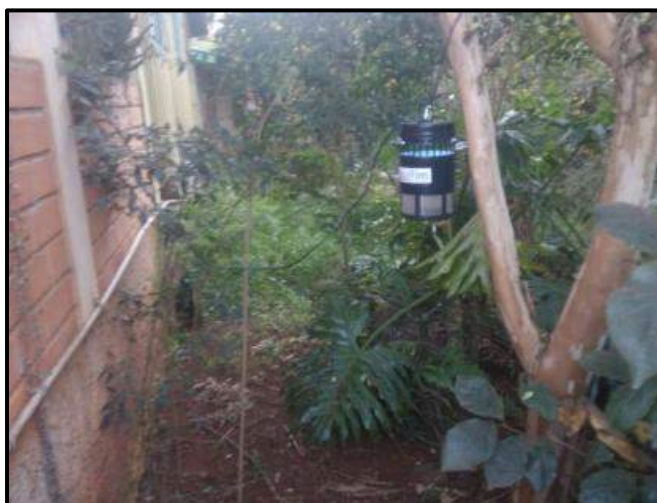
Figura 24 – Armadilha luminosa do tipo CDC modificada utilizada para monitoramento de vetores.
